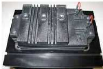
6.5 kV/25A IGBT Module
