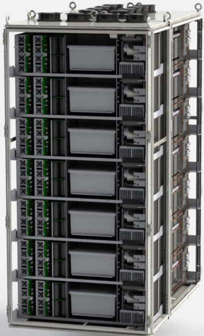
NCSU 1MVA SST
